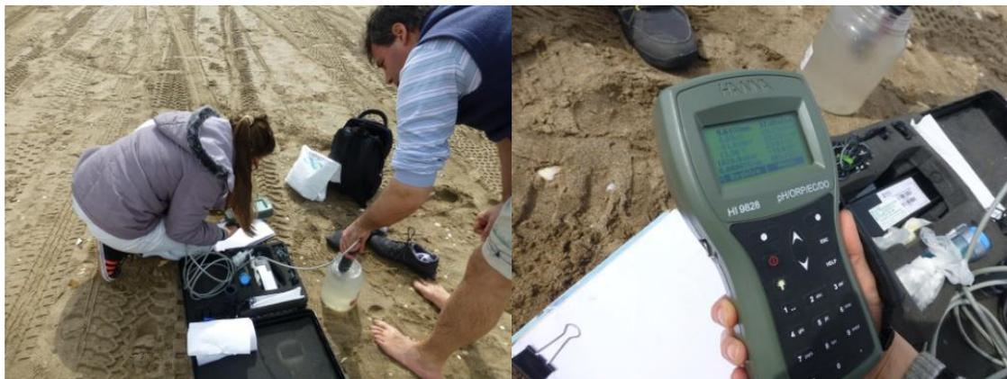
Determinación de muestras de agua con sondas multiparamétricas.
