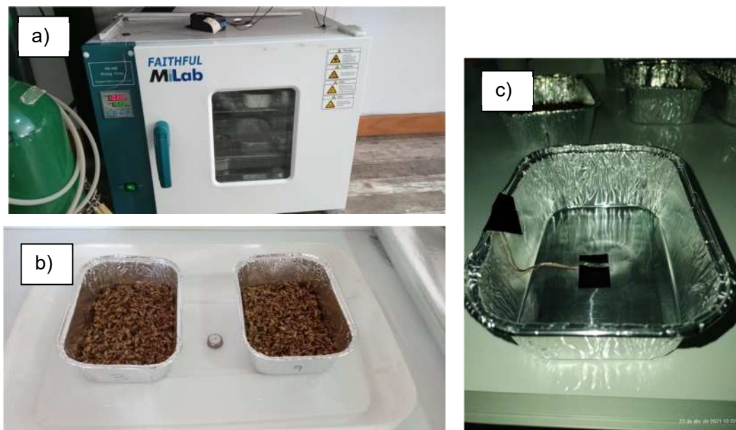
Figura 1. BGS dentro de la estufa en bandejas. Registro de temperatura del proceso mediante datalogger. Bandejas conteniendo bagazo con 1cm de espesor. Bandeja con termocupla tipo T.
