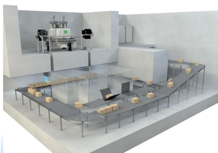
Figura 2. Instalación típica de Aceleradores de Electrones/Rayos X. (Fuente: IBA)
